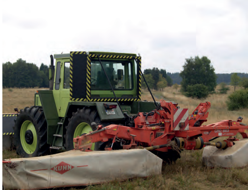
Auf einer Teilfläche der DBU-Naturerbefläche Stegskopf wurde versuchsweise ein Traktor mit Panzerglas und speziellem Unterbodenschutz zur Pflege der Trollblumenwiesen eingesetzt.
