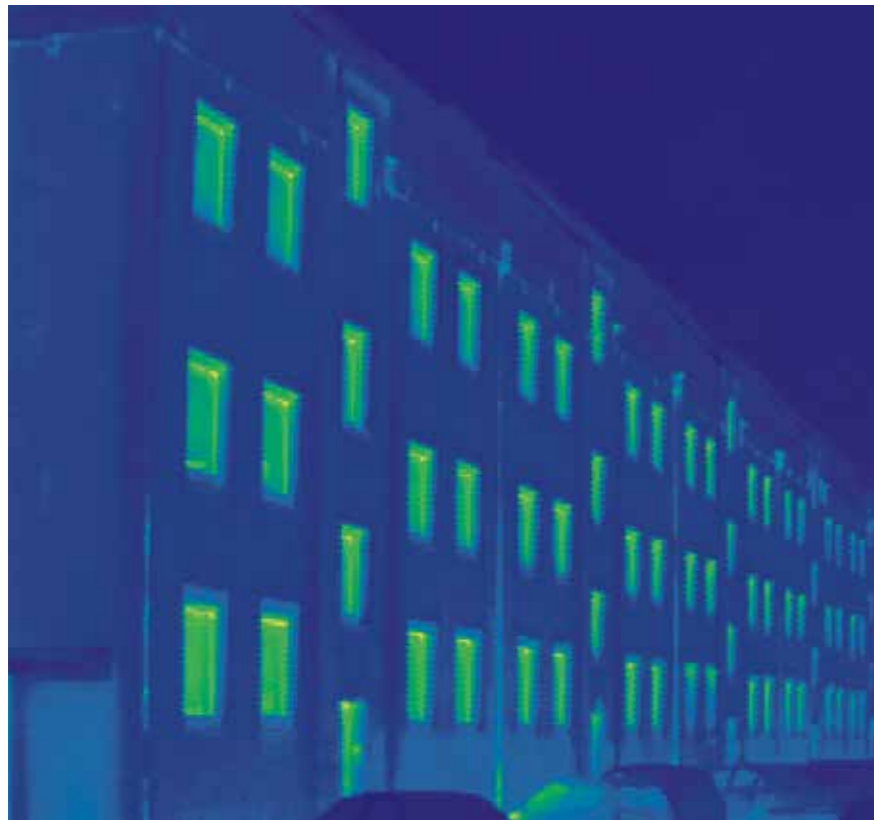
... aus den 50er Jahren so saniert wurde, dass er Passivhaus-Standard erfüllt. Die Wärmebilder zeigen, dass nur noch wenig Wärme entweicht.
