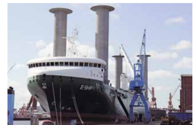
E-Ship 1: Mit den hohen rotierenden Zylindern wird der Wind auf hoher See eingefangen und Diesel eingespart.
