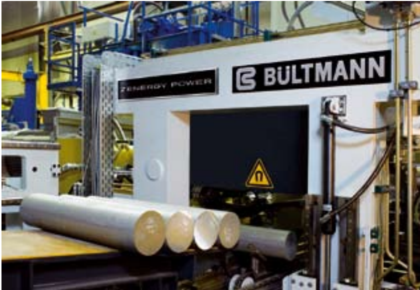
Der neue Induktionsheizer bei der Firma Weseralu (Minden) im Einsatz
