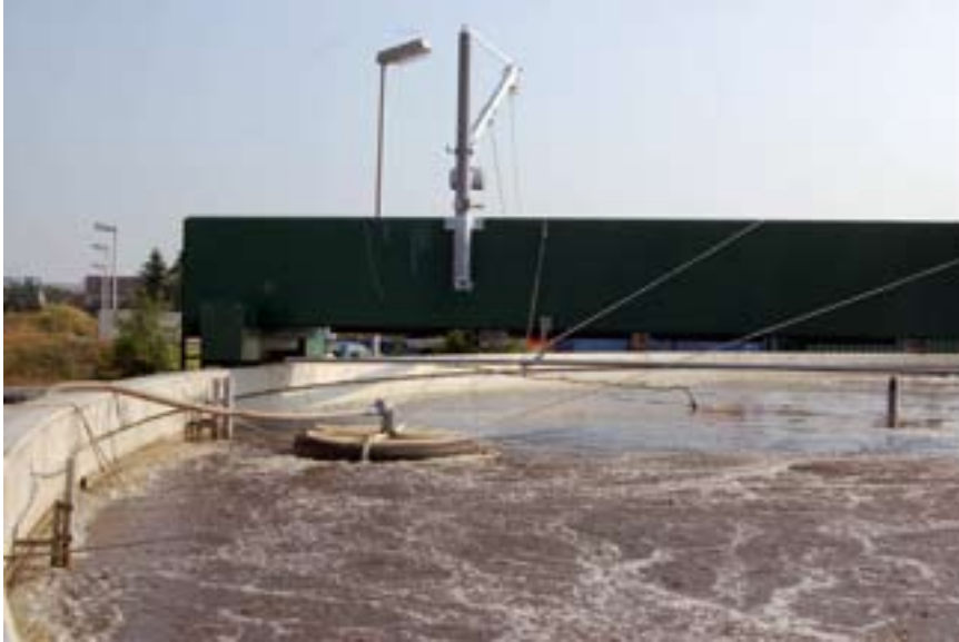
Die »Ablufthaube« im Praxiseinsatz zur Messung des Sauerstoffeintrags und des Belüfterbetriebs.
