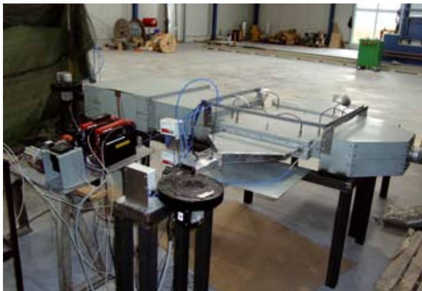
Aufbau des Versuchsstandes zur Prüfung der Funktionstüchtigkeit des neuen Wärmetauschers
