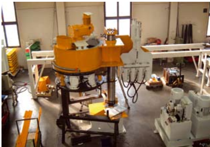
Der Dosator mit Materialsilo, Mischergetriebe, Dosierventilen und Steuerhydraulik
