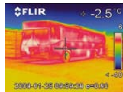
Bei Aufheizversuchen im Winter liefert die Wärmepumpe ausreichend Heizleistung – wie die Thermografie des Busses belegt.
