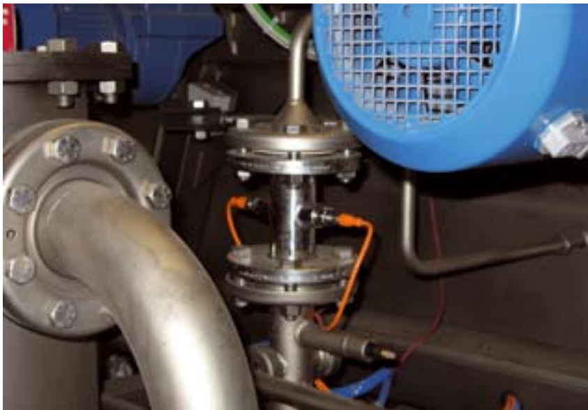
Der Farbigkeitssensor lässt sich beliebig im Veredlungsprozess platzieren.
