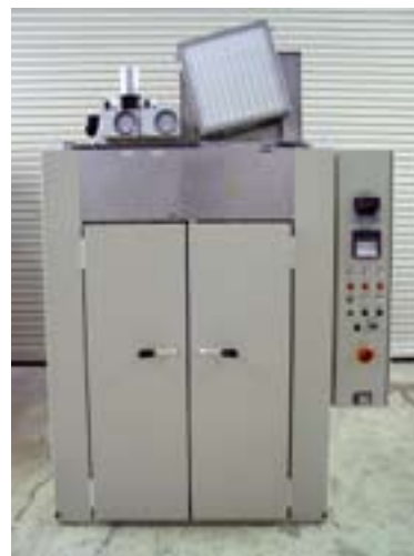
In Lacktrockenschränken fehlt bisher eine effiziente Wärmerückgewinnung.
