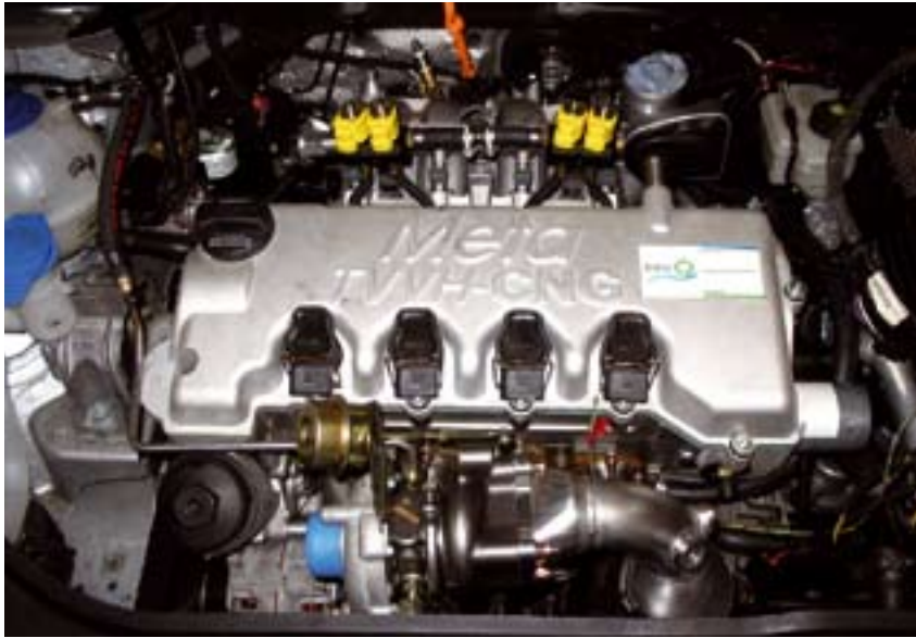
Ein 1.4-l-Serien-Ottomotor wurde mit vollvariabler Ventilhubsteuerung und Erdgasbetrieb ausgerüstet.
